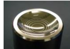
プラスチックレンズ金型 P-V:0.1μm 以下 Ra:0.7nm
