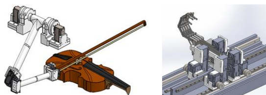
(a) 運弓装置 (b) 運指装置 図5 ヴァイオリン自動演奏装置
