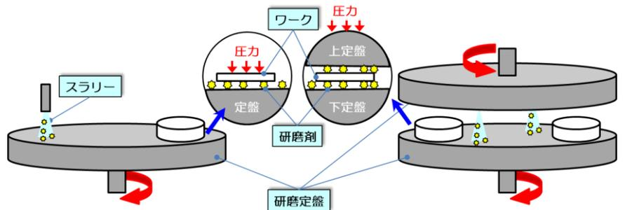
片面研磨機、両面研磨機による研磨加工
